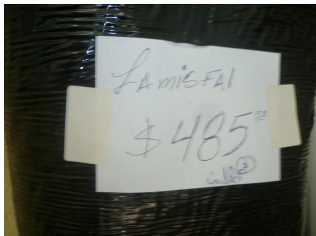
Rollo de manta impermeable LAMISFAL, de producción cubana, que tiene 10 m<sup>2</sup> y cuesta \$ 485 pesos en MN. Se pierde un 10 % en los solapes entre capas de la manta. Fotos: El Autor.
