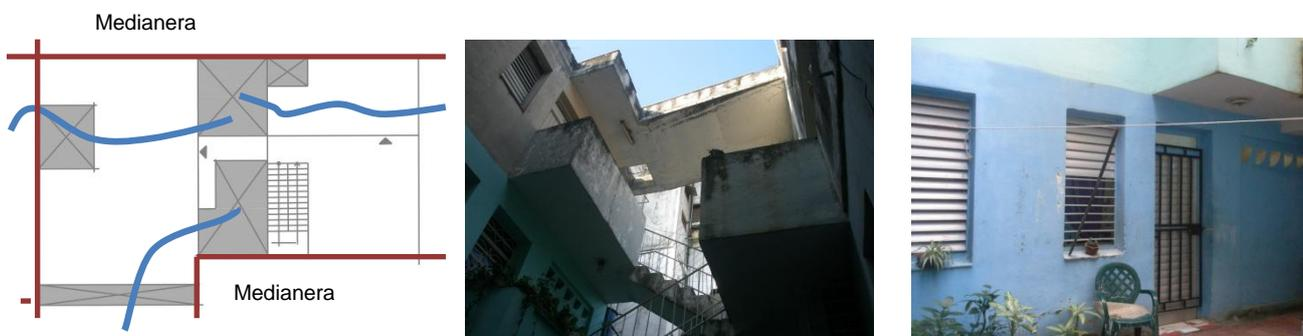
Figura 3.2. Esquema planimétrico de tipología Pareada con patio transversal, se produce el intercambio bioclimático en todos los locales a pesar del tamaño del lote. Imagen de patio central y escalera techada, colocada en el patio para aprovechar al máximo el espacio descubierto, se han agregado balcones. Vivienda en planta baja. Fuente: autora,
