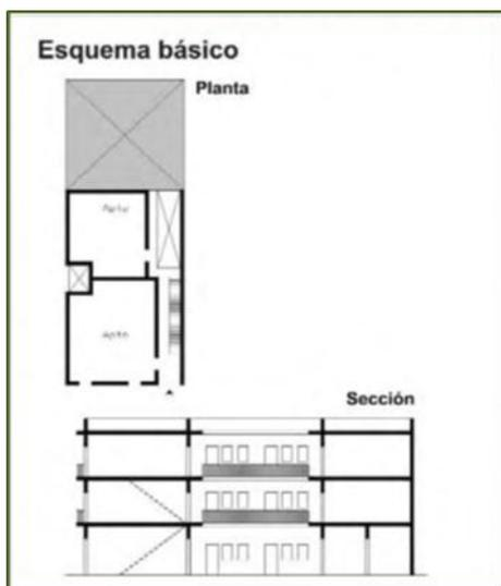
Su esquema básico estaba definido por varias viviendas en un nivel y un acceso común que concentraba las escaleras y elevadores. Utilizaron para la ventilación, la solución de patinejos, patios laterales y pasillos; la comunicación horizontal se establecía por corredores centrales o laterales. Figuras 2.7, 2.8 y 2.9. Eran más beneficiados los apartamentos más altos, cuando quedaban libres de las paredes medianeras.
